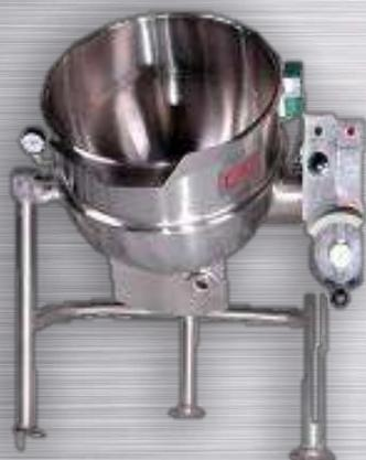
Marmita eléctrica de volteo en aisi-304 capacidad útil de 80l , la olla construida aisi-304 calefacción eléctrica mediante resistencias , control mediante contactor, termostato y válvula de seguridad
